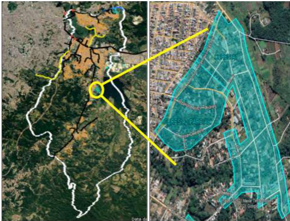
Figura 50 – Pacote 2 – Redes coletoras de esgoto no Chácara Ceres Área 1 e Área 2 Parcial
