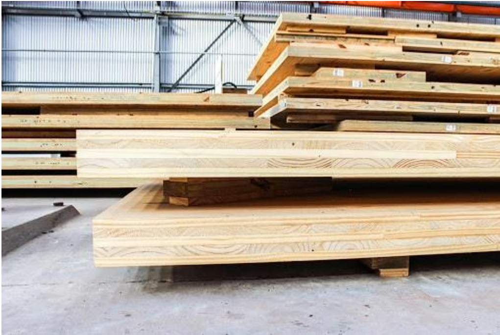
Imagem 10 – Painéis de Madeira Laminada Cruzada fabricados pela CG Sistemas Construtivos
