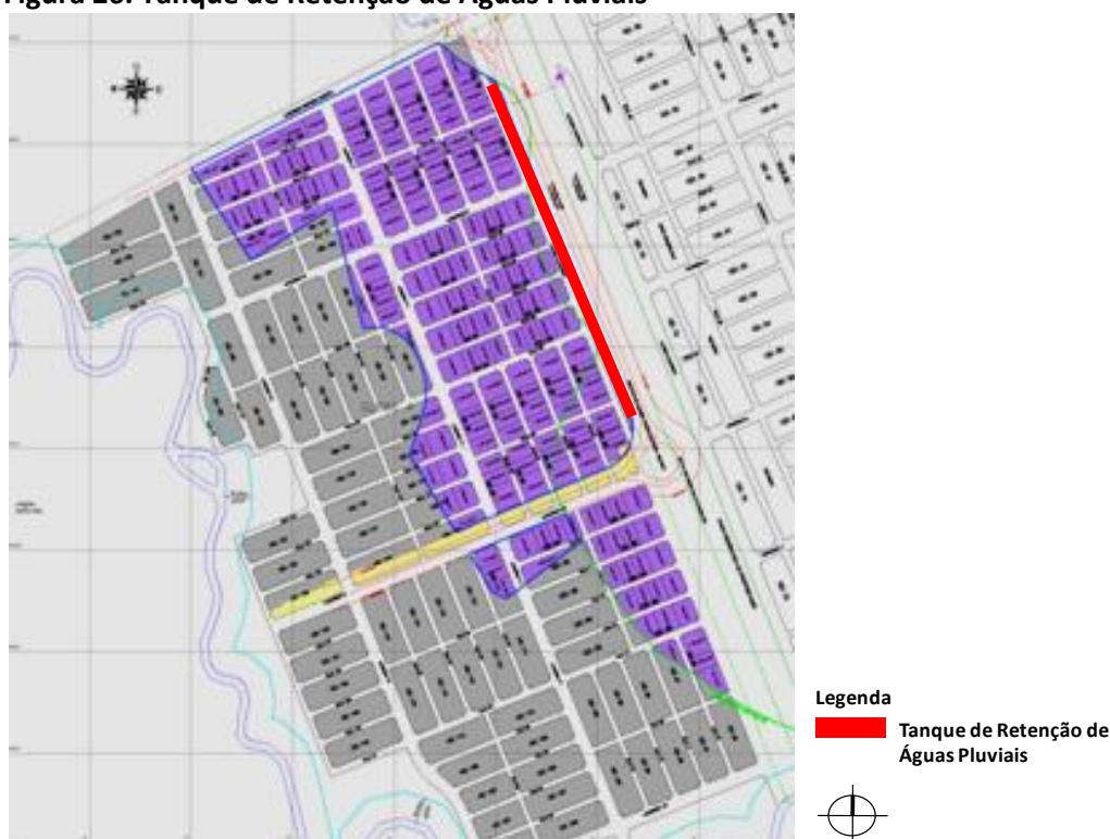
Figura 26. Tanque de Retenção de Águas Pluviais
